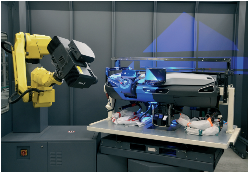
Bild 1: Für Analysemessungen und die serienmäßige Qualitätskontrolle der ZSB-Cockpits setzt SAS seit 2019 die optische 3D-Koordinatenmessmaschine ATOS ScanBox ein © GOM Metrology
